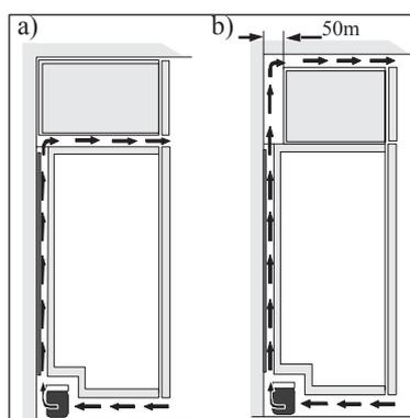
Извлеките из прилагаемого к машине пакета два распорных элемента, обеспечивающих зазор между стенами и прибором и закрепите их согласно рисунку, расположенному сверху на задней стороне прибора, с тем чтобы между стенами и прибором появилось необходимое пространство для вентиляции.
