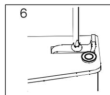
6. Открутите винт фиксатора двери
