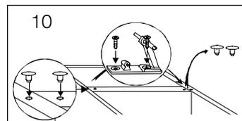
11. Переверните оборудование двери в противоположное положение. Вставьте новую заглушку в отверстие нижней двери.
