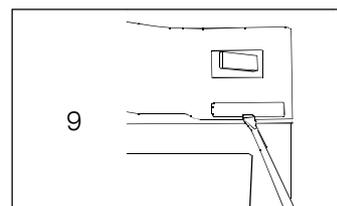
10. Промежуточная балка: выньте пластмассовые заглушки с помощью дорна. Переставьте среднюю петлю на противоположную сторону. Выровняйте вышедшее из отверстий петли волокно и вставьте в отверстия новые заглушки.
