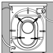
Транспортировочные винты должны быть удалены до того, как вы начнете пользоваться машиной. Образовавшиеся отверстия закройте пластиковыми заглушками (входят в комплект поставки машины).
