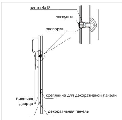
Рис. 4b. Крепление декоративной деревянной панели.
