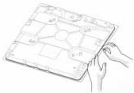
Установите варочную панель в монтажный проем столешницы, вырезанный по размерам, указанным в Листке описания изделия
