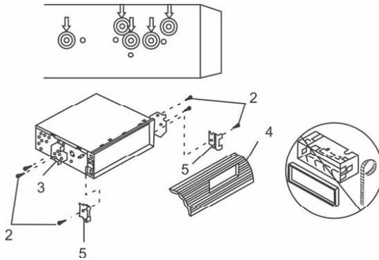
Данный вариант установки предусматривает использование резьбовых отверстий, которые находятся на боковых панелях CD-ресивера.
