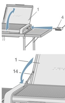
**Блок управления (4) невозможно вставить в прибор, если закрыта защитная крышка (1).**
