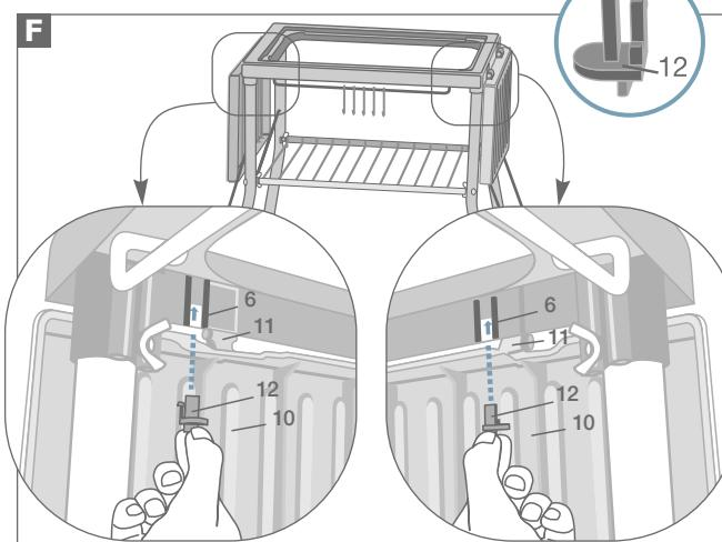
Для того, чтобы зафиксировать откидные полки (10) вставьте фиксаторы (12) в специальные пазы. Они расположены с внутренней стороны поддерживающей рамы (6).
