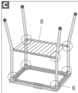
Повторите шаг В на противоположном углу полки для хранения (8), теперь конструкция устойчива.
