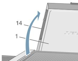
Отсоедините фиксатор (14) и прикрепите его к крышке (1).
