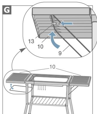
Чтобы расположить откидные полки (10) в горизонтальном положении, поднимите их, затем поднимите откидную опорную скобу (9) вставьте ее в предусмотренные для этого отверстия.
