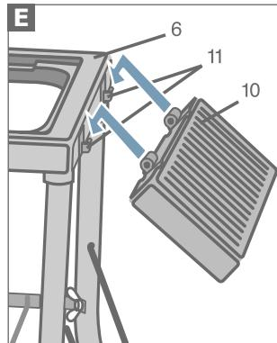
Вставьте откидные полки (10) в предназначенные для этого петли (11) на каждой из сторон поддерживающей рамы (6).
