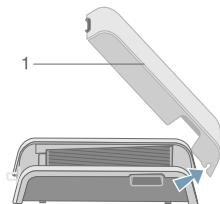
Снимите защитную крышку (1), открыв ее примерно до половины и подняв ее.
