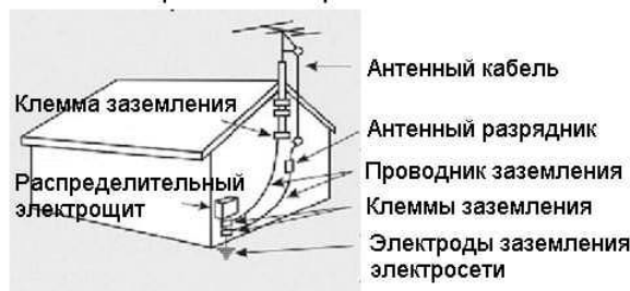
Пример заземления антенны в соответствии с национальными требованиями
