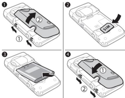
1 Сдвиньте фиксаторы влево и поднимите одну сторону панели аккумуляторного отсека как показано на рисунке. Снимите панель аккумуляторного отсека, повернув ее так, чтобы освободить шарниры на другой стороне панели.
