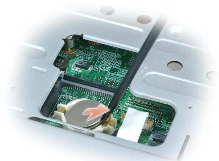
При установке батареи вставьте ее под фиксатор под углом 30 градусов стороной с положительным знаком вверх (сторона отмечена знаком плюс [+]) и затем установите ее на место.
