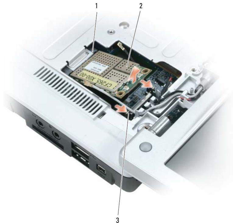
1 разъем на системной плате    2 плата Mini-Card    3 металлические защелки (2)
