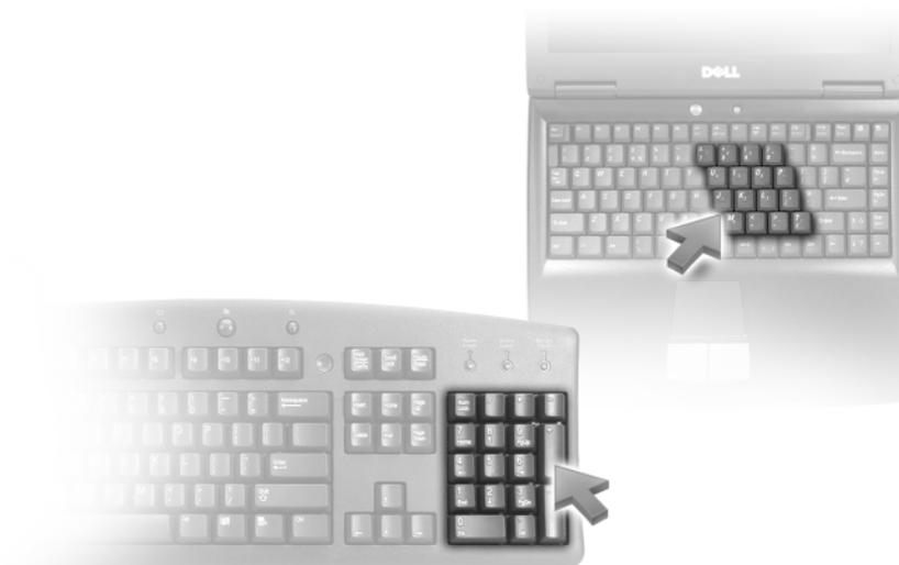
Встроенная цифровая клавиатура работает также как и внешняя цифровая клавиатура. Каждая клавиша выполняет несколько функций. Цифры и символы клавиатуры указаны синим цветом на правой части клавиш клавиатуры. Чтобы ввести цифру или символ, включите цифровую клавиатуру, затем нажмите <Fn> и необходимую кнопку.
