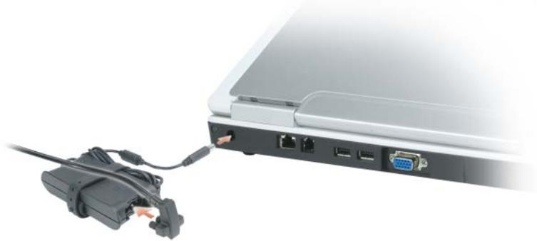
**⚠ ПРЕДУПРЕЖДЕНИЕ.** Адаптер переменного тока работает с электрическими розетками, используемыми во всем мире. Тем не менее, в разных странах используются разные разъемы электропитания и сетевые фильтры. Использование несовместимого кабеля, а также неправильное подключение кабеля к удлинителю или электросети может привести к повреждению оборудования или пожару.
