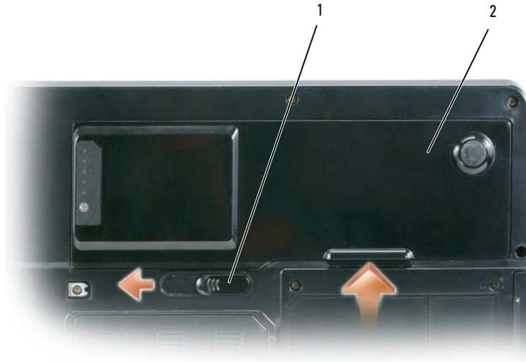
1 защелка аккумулятора      2 аккумулятор
