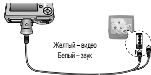
[Подключение аудио- и видеокабеля к фотокамере]
