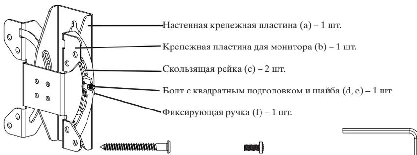
Шуруп для настенного крепления (g) – 2 шт. Винт M4 (h) – 4 шт. Торцовый ключ (i) – 1 шт.
