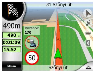
При приближении к первой из камер контроля участка отображаются те же данных, что и на фиксированной камере (предел скорости и расстояния). Находясь между двумя камерами над значком предела скорости отображается постоянно обновляемая средняя скорость.
