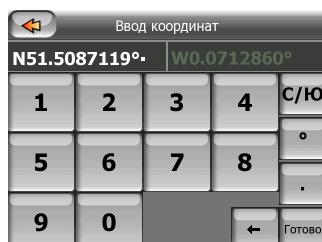
При переходе к данному окну координаты текущего GPS-положения (или выбранного пункта карты; элемент Курсор, если функция Автоследование отключена) отображаются в верхней части дисплея.
