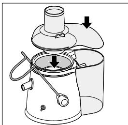
Установите крышку (E) на сокосборнике (G) (при снятии ее следует откинуть назад).
