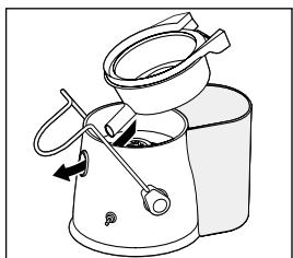
Установите сокосборник (G) в электроприбор, слегка наклонив его вперед и введя носик для слива сока (H) в специально предназначенное отверстие.
