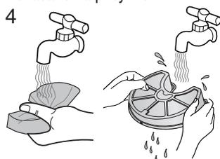
Промойте микрофильтр и кассету водой
