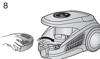
Установите кассету предмоторного фильтра на прежнее место
