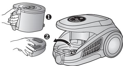
Извлеките контейнер пылесборника и кассету предмоторного фильтра
