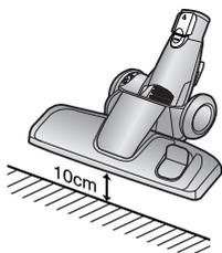
Если индикатор фильтра горит красным, когда всасывающее отверстие находится в 10 см над полом, необходимо произвести очистку предмоторного фильтра.
