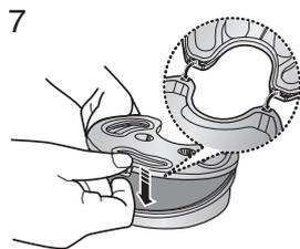
Перед установкой закройте крышку кассеты предмоторного фильтра
