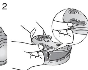
Снимите крышку кассеты предмоторного фильтра
