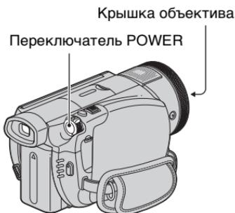
**Удерживая нажатой зеленую кнопку в центре, передвигайте переключатель POWER в направлении стрелки для включения питания.**
