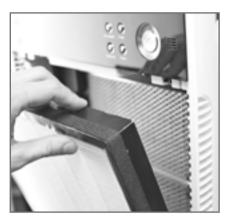
• Составной фильтр: поместите на место сначала нижнюю часть фильтра, а затем слегка надавите верхнюю до фиксации. Фильтр НЕРА должен быть снаружи, а угольный — внутри.
