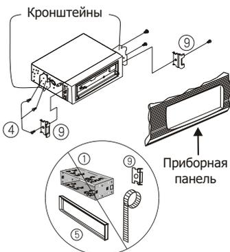
1. Отсоедините винты защелок по обе стороны ресивера и снимите защелки.
