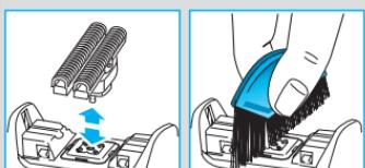
Никогда не используйте воду для чистки бритвы. Самый простой способ чистки после каждого сеанса бритья производится при выключенной бритве. Нажмите кнопки съема бреющей сетки (не снимайте бреющую сетку полностью). Включите бритву приблизительно на 5–10 секунд для удаления сбритых волосков.
