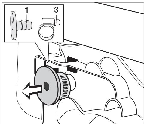
Вы можете подключить сливной шланг с обратным клапаном непосредственно к специальному сифону раковины.
