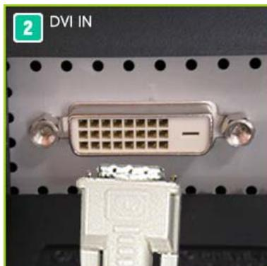
**Порт DVI IN :** Подсоедините кабель DVI к порту DVI IN на задней панели монитора. ( ИСТОЧНИК : Цифр.)
