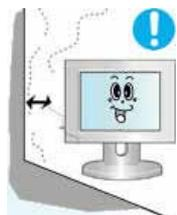
• **При установке необходимо оставить зазор между изделием и стеной (более 10 см/4 дюйма), чтобы не препятствовать вентиляции.**
