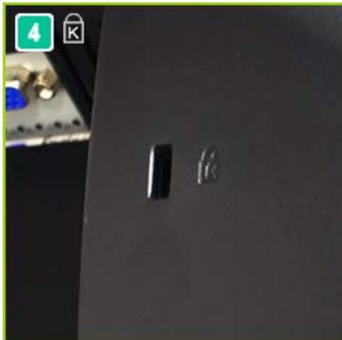
**Kensington Lock** : Kensington lock - это устройство для жесткого крепления системы при использовании ее в общественных местах.
