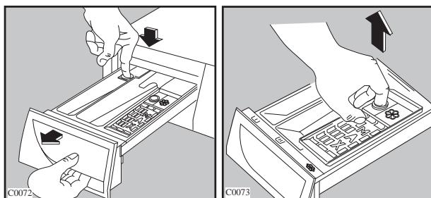
Стиральный порошок скапливается и в углублении дозатора. Для чистки углубления можно использовать старую зубную щетку. После чистки установите дозатор на место, и включите программу стирки без белья.
