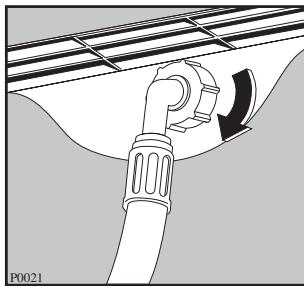
Подключите напливной шланг к водопроводному крану с резьбой 3/4".
