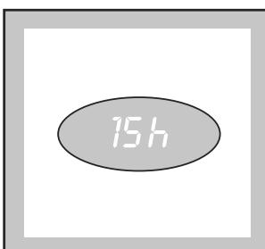
Время задержки появляется на 3 секунды, после чего высвечивается продолжительность выбранной программы. После нажатия кнопки СТАРТ/ПАУЗА начинается отсчет, и значение задержки уменьшается на одну единицу в час. Задержку включения выбранной программы можно отложить до 23 часов с интервалами в один час.
