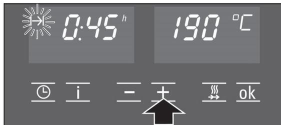
7. Запустите с помощью «ок» или установите время окончания на более позднее, как описано в разделе «Автоматическое включение и выключение духового шкафа».
