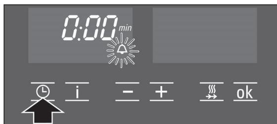
2. Установите время таймера с помощью поля «Плюс» + или «Минус» -.
