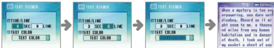
**Секунды.** – Функция авто-чтения будет работать согласно установленному Вами интервалу в секундах. Если Вы установили время 0 секунд, функция будет работать как чтение вручную.
