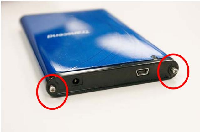
2. Снимите крышку с устройства **Transcend StoreJet**, открывая контроллер адаптера, который преобразует IDE интерфейс жесткого диска в интерфейс mini USB 2.0.
