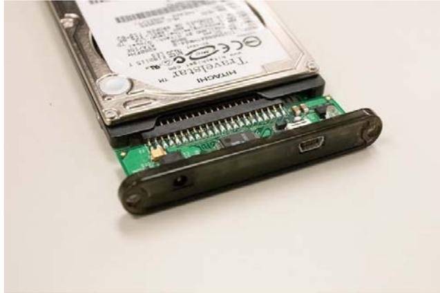
4. Вставьте жесткий диск с подсоединенной к нему платой контроллера в корпус **Transcend StoreJet**.
