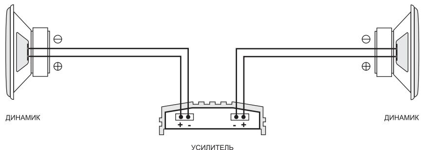
B) Схема подключения компонентных динамиков.
