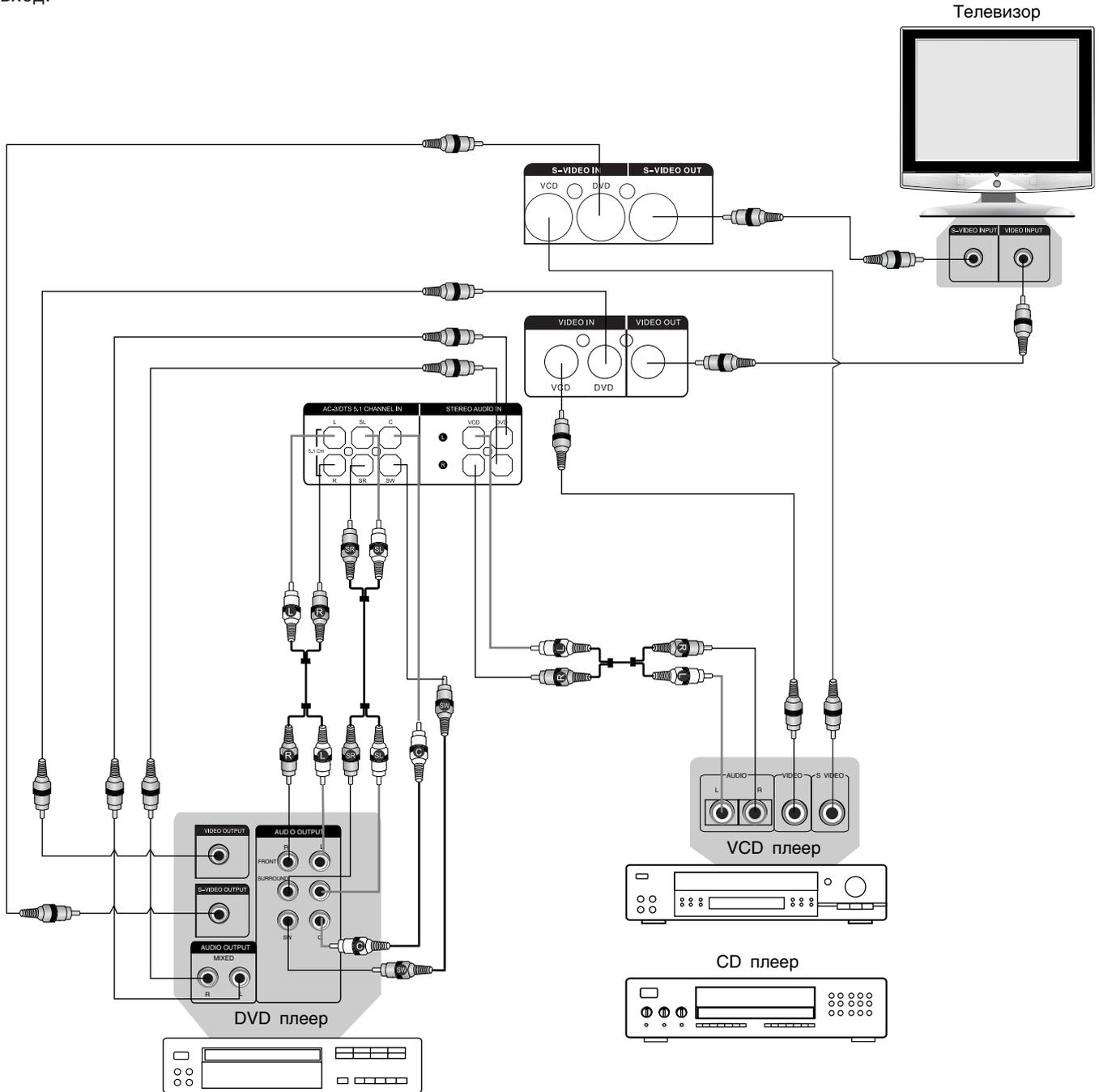
Используйте для подключения соединительные кабели RCA ("тюльпан") минимально возможной длины. Убедитесь в правильности и надежности подключений, в противном случае звук будет воспроизводиться с искажениями.
