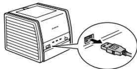
Функцию [УДОБ ПЕЧАТ] можно использовать, даже если фотокамера выключена или находится в режиме съемки. Когда фотокамера выключена или находится в режиме съемки, подсоедините кабель USB. Отображается экран выбора для соединения USB. Выберите [УДОБ ПЕЧАТ].
