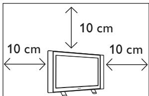
Оставьте как минимум по 10 см свободного места с каждой стороны телевизора, чтобы обеспечить надлежащую вентиляцию. Установите телевизор на устойчивой и плоской поверхности. Никогда не закрывайте вентиляционные отверстия телевизора тряпками или другими материалами. Не вставляйте ничего в вентиляционные отверстия. Если в эти отверстия вставлены металлические или легковоспламеняющиеся предметы, это может привести к пожару или короткому замыканию.
