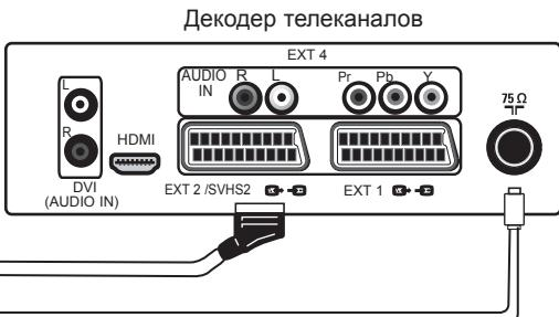
Разъемы устройств приведены только для справки. Разъемы ваших устройств могут обозначаться по другому и находиться в других местах.
