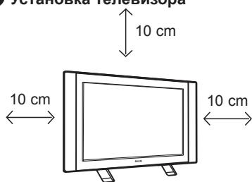
1 Размещение телевизора Поставьте Ваш телевизор на прочную устойчивую поверхность, оставляя по 10 см с каждой стороны телевизора.
