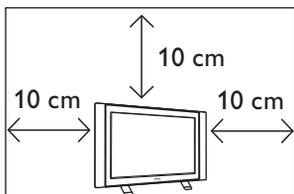
Оставьте как минимум по 10 см свободного места с каждой стороны телевизора, чтобы обеспечить надлежащую вентиляцию. Установите телевизор на устойчивой и плоской поверхности. Никогда не закрывайте вентиляционные отверстия телевизора тряпками или другими материалами. Не вставляйте ничего в вентиляционные отверстия. Если в эти отверстия вставлены металлические или легковоспламеняющиеся предметы, это может привести к пожару или короткому замыканию.
