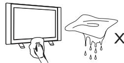
Осторожно протирайте поверхность экрана с помощью гигроскопической ваты или других мягких материалов, например, замши. Не пользуйтесь слишком мокрой тряпкой, с которой капает вода. Для чистки телевизора не пользуйтесь ацетоном, толуолом или алкоголем. Для безопасности выньте электрический провод из розетки.
