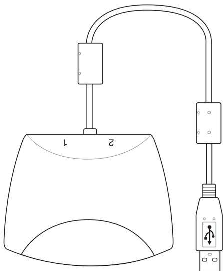
Подключите инфракрасный приемник к USB порту ноутбука. Инфракрасный пульт должен использовать этот приемник, а не инфракрасный приемник ноутбука.
