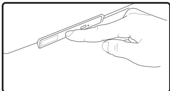
Выдвиньте лоток и осторожно поднимите край диска вверх под углом для снятия диска.
