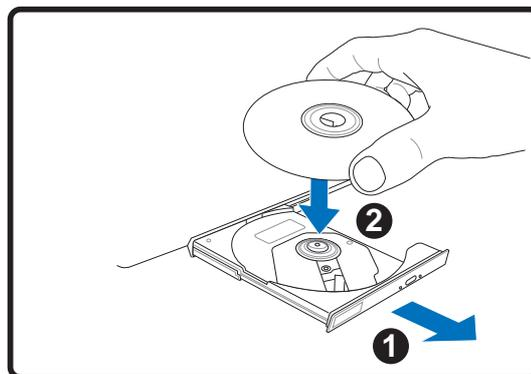
2. Осторожно потяните за переднюю панель привода и полностью выдвиньте лоток. Будьте осторожны и не касайтесь линз дисководов и других механизмов. Убедитесь, что никакие предметы не будут зажаты движущимся лотком привода.
