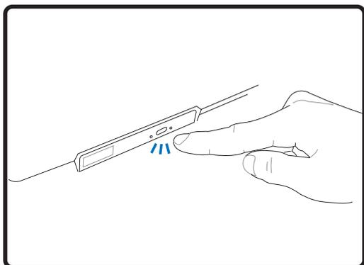
1. Когда портативный ПК включен, нажмите кнопку открывания на приводе, и его лоток будет частично вытолкнут наружу.
