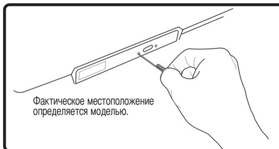
Аварийное извлечение используется для извлечения лотка привода в случае если обычным способом этого сделать не возможно. Не используйте аварийное извлечение вместо обычного.
