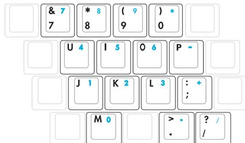
на внешней клавиатуре, нажмите на клавиши [Fn][Ins/Num LK] на клавиатуре портативного компьютера.
