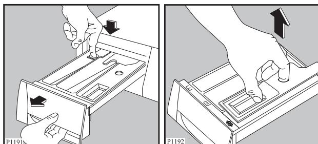
Стиральный порошок скапливается и в углублении дозатора. Для чистки углубления можно использовать старую зубную щетку. После чистки установите дозатор на место, и включите программу стирки без загрузки белья.
