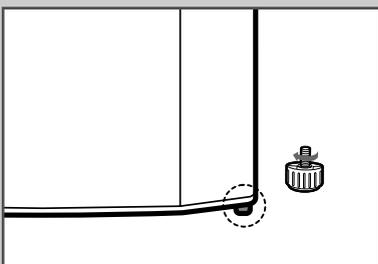
*Для компенсации неровности пола вы можете отрегулировать высоту ножек, расположенных в передней части холодильника/ морозильника.*
