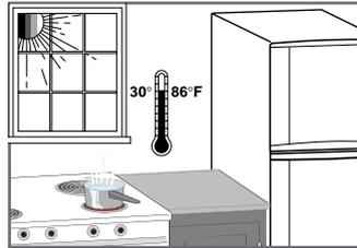
Не устанавливайте изделие в местах, подверженных воздействию прямого солнечного света или рядом с нагревательными приборами, радиаторами отопления, печами или кухонными плитами.
