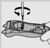
**6** С помощью отвертки снимите крышку блока питания.
