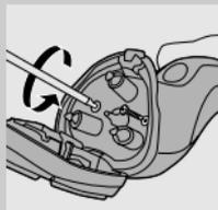
**2** После того, как энергия аккумуляторов электробритвы будет выработана, и прибор полностью остановится, отвинтите два винта на задней стороне бритвы.
