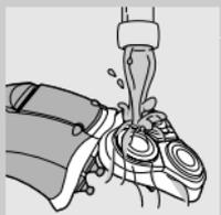
**3** Очистите бритвенный блок и отсек для волос, промыв их под струёй горячей воды.
