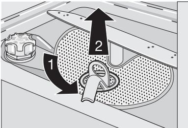
4. Взявшись за ручку с отверстием, извлеките фильтр грубой очистки (A) из микрофильтра (B).
