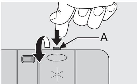
2. Залейте ополаскиватель в емкость. Максимальный уровень заполнения соответствует отметке "max".
