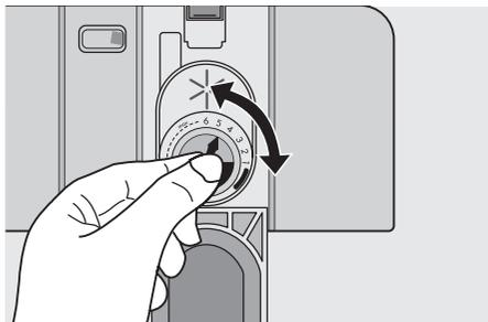
Дозировка установлена заводом-изготовителем в положение 4.
