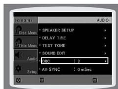
**4** С помощью кнопок **▲**, **▼** произведите регулировку сжатия динамического диапазона.
