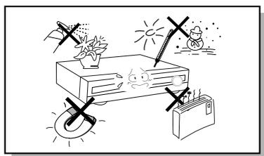
Предохраняйте систему от влаги (не ставьте на нее сосуды с водой, например, вазы), держите ее подальше от источников тепла (например, камина) и от оборудования, создающего сильные магнитные или электрические поля (например, громкоговорителей). Если система неисправна, отсоедините сетевой шнур от розетки сети переменного тока. Ваша система не предназначена для коммерческого использования. Используйте ее только в домашних условиях.
