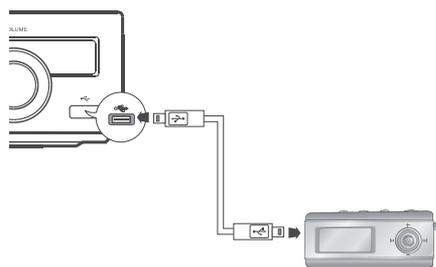
**2** Нажатием кнопки **FUNCTION** (Функция) на основном блоке или кнопки **USB** на пульте ДУ выберите режим USB.
