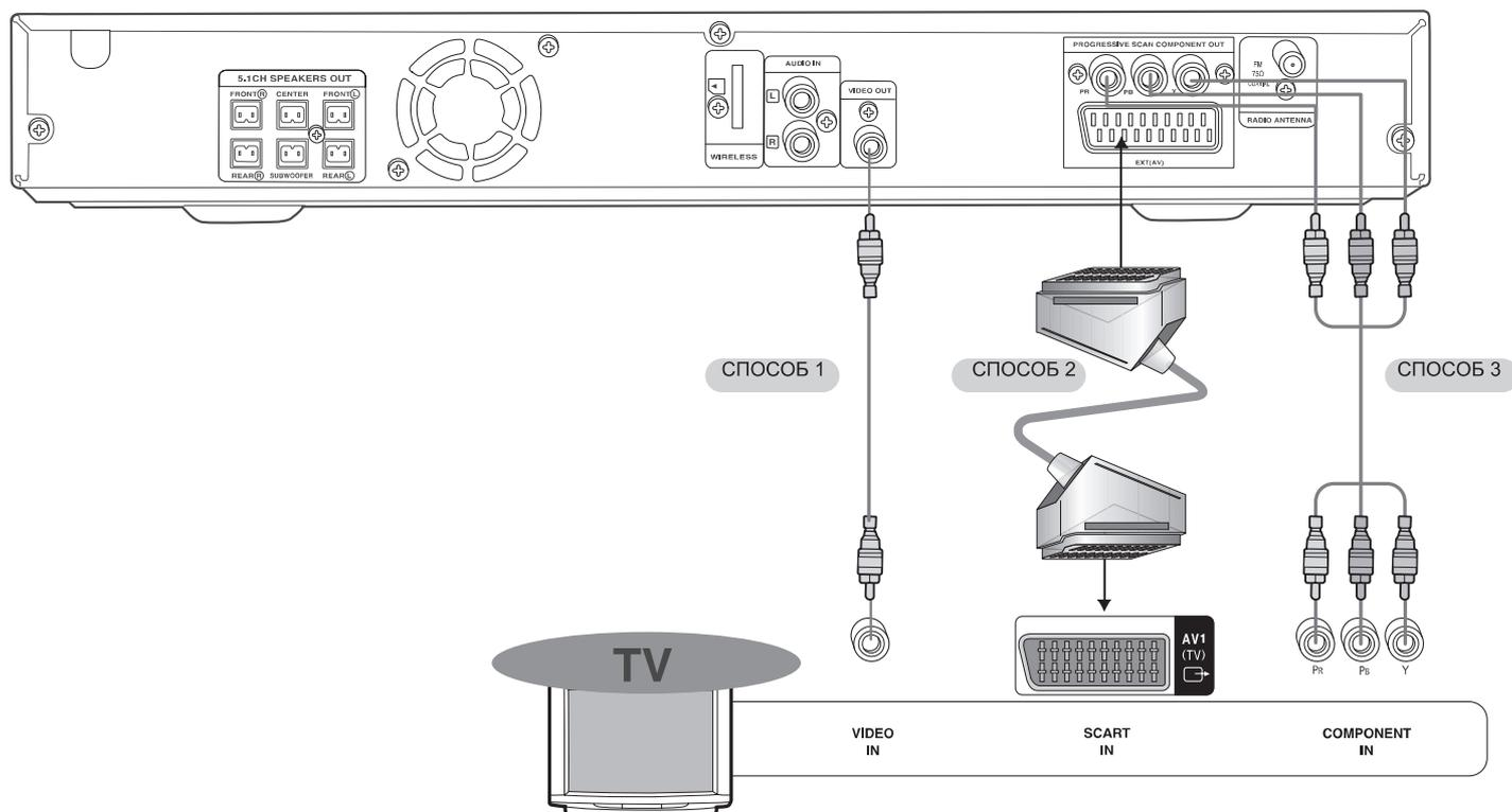
**СПОСОБ 1 Выход композитного видеосигнала ----- Изображение хорошего качества**
