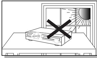
Избегайте воздействия на систему прямого солнечного света и других источников тепла. Это может привести к перегреву системы и нарушению ее нормальной работы.
