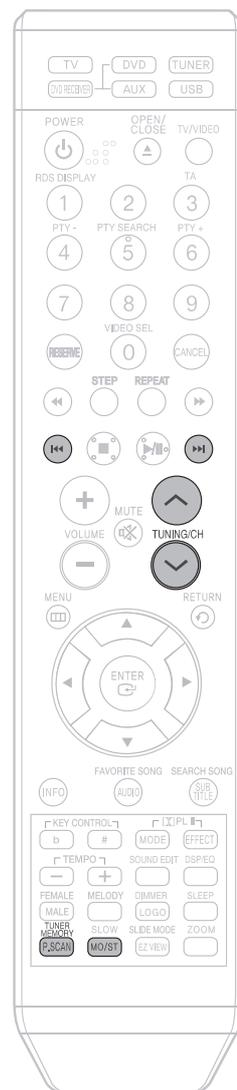
Нажмите кнопку **MO/ST** (Моно/Сtereo) для выбора прослушивания в монофоническом или стереофоническом режиме (Эта кнопка действует только при прослушивании радиопередач в диапазоне FM).
