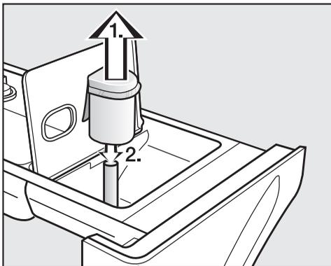
1. Вытяните сифон из ячейки
