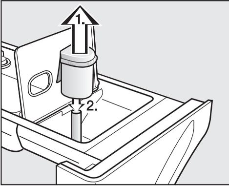
1. Вытяните сифон из ячейки
