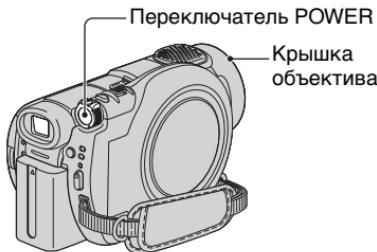
**1 Для включения питания переместите переключатель POWER в направлении стрелки при нажатой зеленой кнопке в центре переключателя.**
