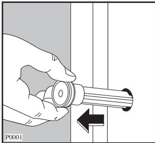
3. Закройте открытые отверстия заглушками, которые находятся в пакете с инструкцией по эксплуатации.
