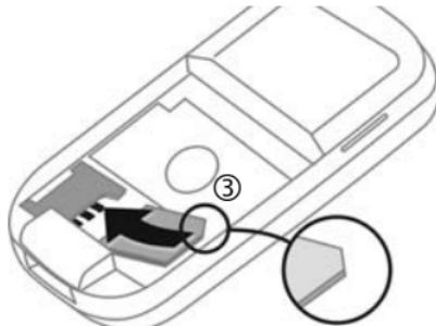
Закройте крышку аккумуляторного отсека
