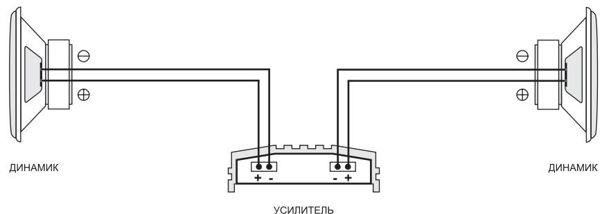
B) Схема подключения компонентных динамиков.
