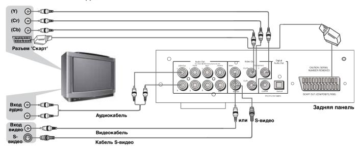
Плейеры DVD85 и 89 имеют широкий набор видеовыходов. Вам следует всегда использовать подключение наивысшего качества, поддерживаемое вашим телевизором . Для улучшения качества Вам следует использовать один из разъемов: композитный (CVBS), S-видео, RGB Scart, компонентное видео (YUV), DVI и, наконец, HDMI.
