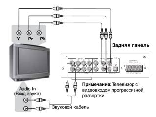
Если ваш телевизор с построчной разверткой имеет видеовходы Y, Pb Pr, то Вы можете использовать выходы плейера Y, Cb/Pb, Cr/Pr. Нажмите кнопку 'P-Scan', чтобы переключить плейер в режим построчной развертки видеовыхода.
