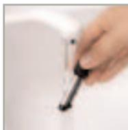
Для полной очистки паровое сопло можно снять. Сполосните сопло водой с помощью щётки и с добавлением средства для мытья посуды без шлифовального эффекта. Сполосните его и просушите. Перед установкой убедитесь, что все отверстия для подачи воздуха свободны.
