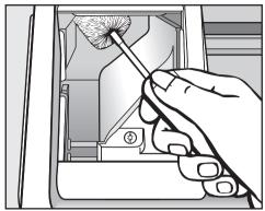
■ С помощью ершика для мытья буть тылок удалите остатки моющих средств и отложения извести с форсунок подачи воды в отсеке для моющих средств.
