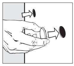
4 больших отверстия закройте прилагаемыми заглушками.
