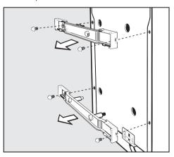
Снимите транспортировочные крепления.
