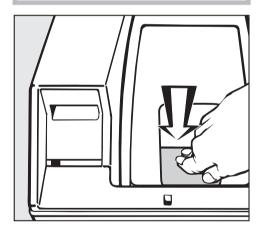
Закройте внутреннюю крышку легким нажатием на замок так, чтобы был слышен четкий звук фиксации.
