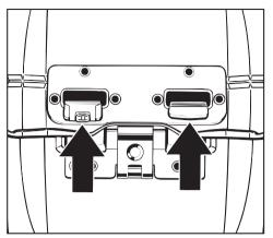
Надавите сначала на переднюю, а затем на заднюю створку люка так, чтобы оба фиксирующих крюка зацепились до отчетливого соединения.
