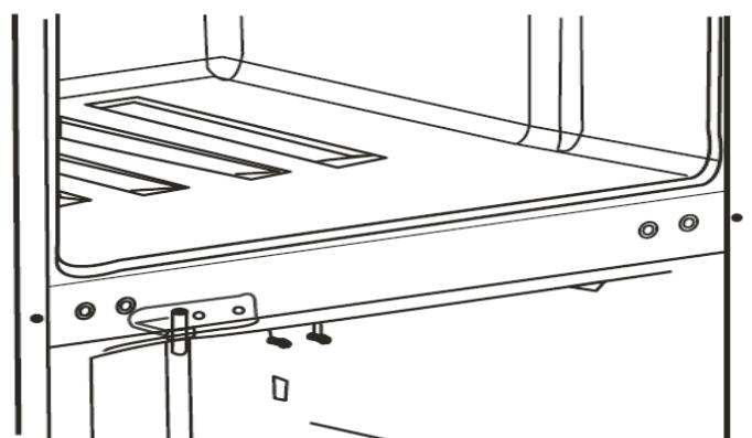
9) Установите дверь морозильной камеры и верхнюю петлю. Убедитесь, что дверь морозильной камеры плотно прилегает к корпусу и неперекошена. Зафиксируйте петлю и установите верхнюю крышку холодильника. Закройте винты декоративными заглушками.
