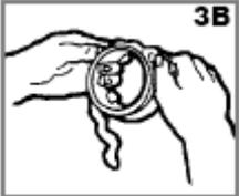
3B вместо прокладки образовать кольцо вокруг нижней стороны сливного фланца (см. 3D). Вставить фланец в сливное отверстие мойки, плотно прижать его вниз, чтобы выдавить избыток герметика (см. 3D). Удалить выдавленные излишки с нижней кромки отверстия.
