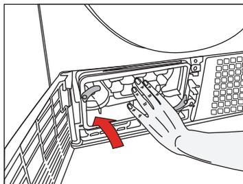
6. Закройте крышку предохранительной пластинки.
