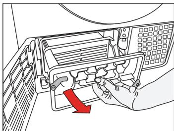
4. Очистите конденсатор из распылителя водой под давлением и подождите, пока она стечет.
