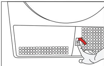
2. Откройте 2 стопорных рычажка после того, как открыли предохранительную пластинку.
