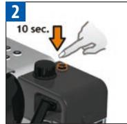
Нажмите и удерживайте кнопку “CLEAN” до тех пор, пока помпа кофе-машины не выключится автоматически. Кнопка приготовления молока мигает: процесс очистки занимает порядка 10 секунд. Кнопка горит постоянным светом: процесс очистки завершен.
