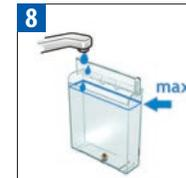
Опустошите контейнер для сбора капсул и поддон для капель. Промойте и заполните резервуар для воды чистой питьевой водой до максимального уровня (отметка MAX). Повторите процесс 5 раз.
