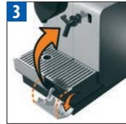
Откройте крышку отсека для хранения насадки для очистки от накипи. Вставьте насадку для очистки от накипи в коннектор подачи пара на кофе-машине.
