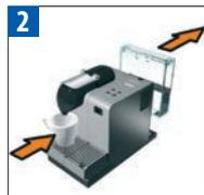
Снимите резервуар с водой. Закройте капсулодержатель (без капсулы внутри). Поставьте пустую емкость под носик кофе-машины.
