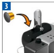
Полностью поднимите рычаг капсулодержателя и вставьте капсулу Nespresso.
