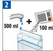
Опустошите контейнер для сбора капсул, поддон для капель и капсулодержатель. Заполните резервуар для воды средством для очистки от накипи *Nespresso* в объеме 100 мл и добавьте 500 мл воды.
