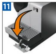
Снимите насадку для очистки от накипи и положите ее в отверстие для хранения. Опустошите и протрите поддон для сбора капель и контейнер для использованных капсул. Наполните резервуар для воды чистой питьевой водой.
