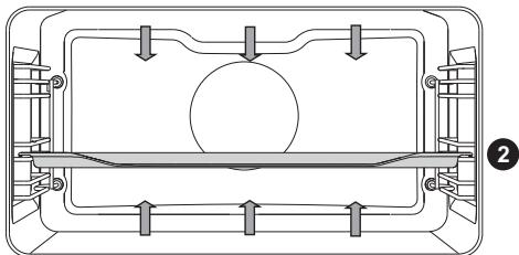
Верхний и нижний нагревательные элементы равномерно излучают тепло внутрь духовки.
