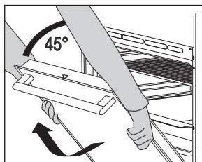
**3** Медленно закрывайте дверцу до угла  $45^{\circ}$  (относительно закрытого положения дверцы), затем приподнимите ее и аккуратно снимите.
