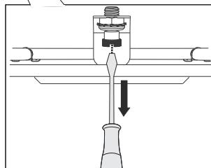
**1** Чтобы освободить верхние нагреватели, открутите винт в передней части потолка духовки.
