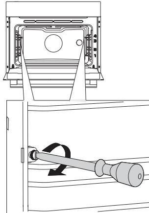
**1** Открутите винт с помощью отвертки.
