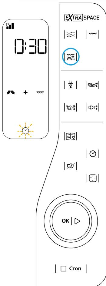
В данном режиме объединены функции микроволнового приготовления и приготовления на гриле, что позволяет сократить время запекания.
