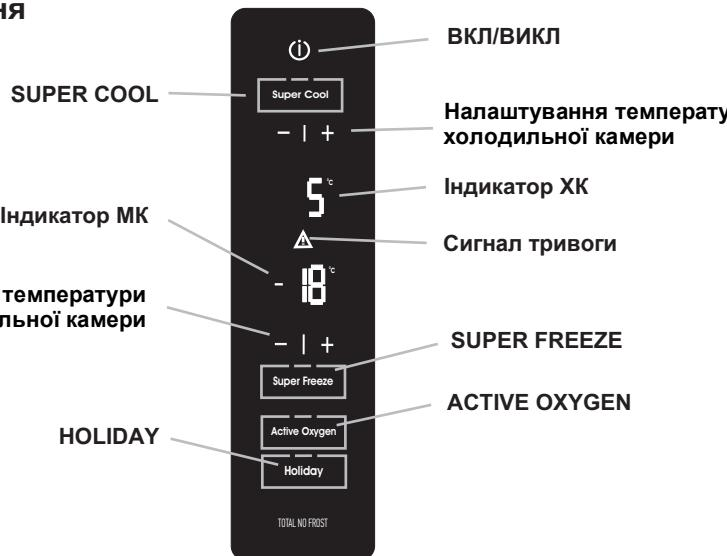
**ВКЛ/ВИКЛ** - натиснанням цієї кнопки можна включити весь прилад в цілому (як холодильну, так і морозильну камери). Для відключення холодильника достатньо натиснути і утримувати протягом 3 секунд кнопку, холодильник вимкнеться із затримкою 6 секунд.
