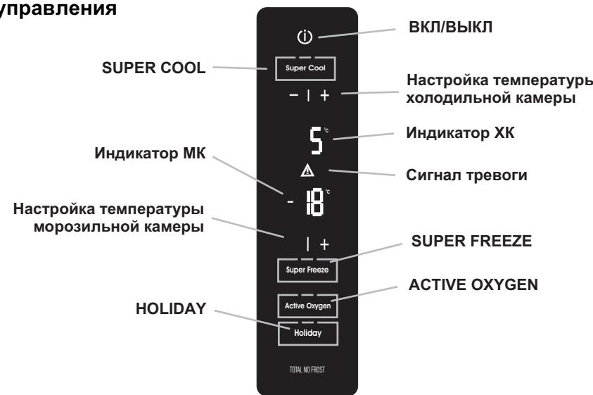
**ВКЛ/ВЫКЛ** - нажатием данной кнопки можно включить весь прибор в целом (как холодильную, так и морозильную камеры). Для отключения холодильника достаточно нажать и удерживать в течение 3 секунд кнопку, холодильник выключится с задержкой 6 секунд.
